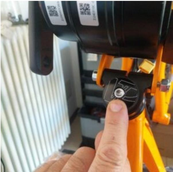
con la chiave a brugola n5 stringere o allentare quanto basta la vite di regolazione fino a togliere il gioco dello sterzo.
