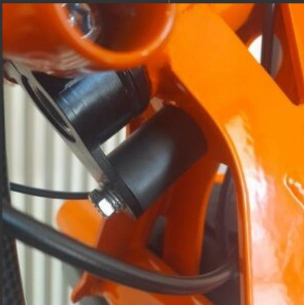
Per regolare la deriva dello sterzo, allentare la vite con una chiave esagonale n13, regolare lo sterzo e serrare la vite. Assicurarsi che le viti siano ben serrate e che il gommino sia integro. Controllare periodicamente lo stato di usura del gommino di sterzo e se necessario sostituirlo con uno dello stesso tipo.
